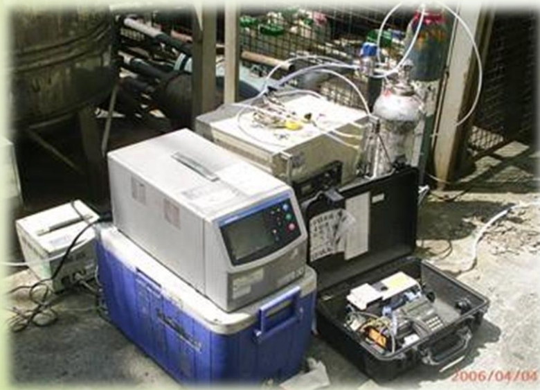
5 in 1 Test Equipment - Test Smoke Stack Fumes for \text{SO}_2 、 \text{NO}_x 、 \text{CO} 、 \text{CO}_2 、 \text{O}_2 and THC (NMHC).
